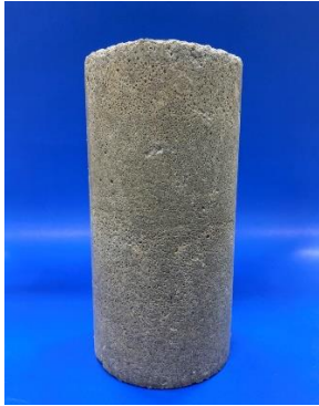
รูปที่ 3 ตัวอย่างคอนกรีตมวลเบาเซลลูลาร์หลังถอดออกจากแบบหล่อ
