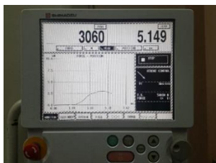
รูปที่ 20 การทดสอบค่ากำลังรับแรงอัดในทิศทางเดียวของก้อนตัวอย่างวัสดุ AMS
