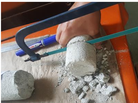
รูปที่ 15 การเตรียมตัวอย่างเพื่อทดสอบกำลังรับแรงอัดที่ทิศทางเดียว
