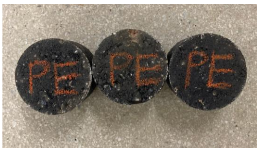
รูปที่ 6 รูปก่อนตัวอย่างแอสฟัลต์คอนกรีตที่ผสมขยะพลาสติก
