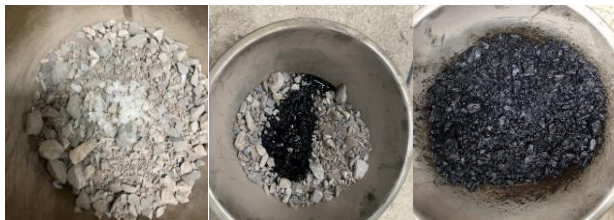
ก. ขยะพลาสติกผสมกับวัสดุมวลรวมร้อน ข. วัสดุมวลรวมเคลือบด้วยซีเมนต์ ค. แอสฟัลต์คอนกรีตผสมขยะพลาสติก
