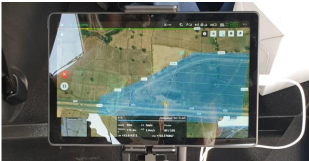
รูปที่ 7 การวางแผนบินและติดตามการบินถ่ายภาพด้วยแอปพลิเคชัน DJI GO 4
