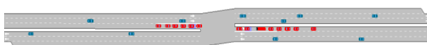
รูปที่ 27 แบบจำลองจุดกลับรถแบบมีช่องรอเลี้ยวและ Loon
