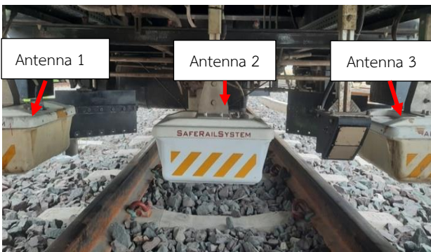
รูปที่ 6 เสาอากาศ 400 MHz ที่ใช้ในการสำรวจของรถเนกประสงค์
