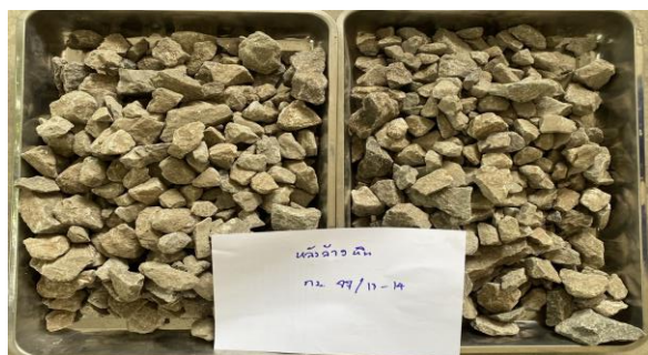
รูปที่ 9 หินตัวอย่างที่นำมาทดสอบหาขนาดคละก่อนและหลังล้างหิน
