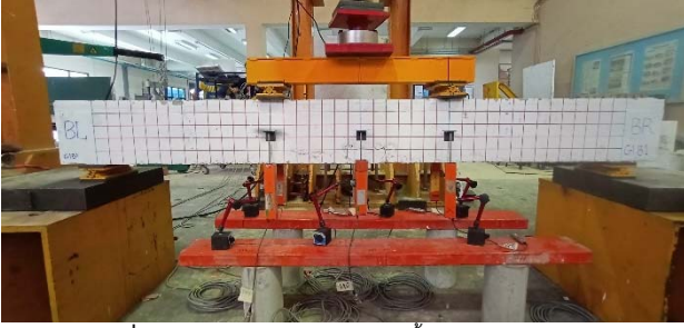
รูปที่ 12 คานควบคุม CB-1S ก่อนให้น้ำหนักบรรทุกกระทำ
