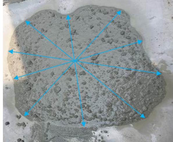
รูปที่ 3 การทดสอบค่าการไหลแผ่ของคอนกรีตตามมาตรฐาน ASTM C1611/C1611M-14 [11]
