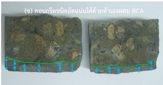
รูปที่ 6 การแพร่กระจายของคลอไรด์ของคอนกรีต (ก) คอนกรีตชนิดอัดแน่นได้ด้วยตัวเองผสม NCA และ (ข) คอนกรีตชนิดอัดแน่นได้ด้วยตัวเองผสม RCA
