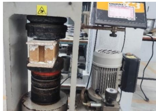
รูปที่ 5 การทดสอบความต้านทานแรงอัดของอิฐบล็อกประสาน
