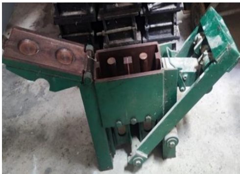
รูปที่ 3 เครื่องอัดขึ้นรูปอิฐบล็อกประสานแบบมือโยก (CINVA-Ram machine)
