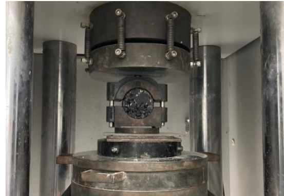
รูปที่ 8 การทดสอบเสถียรภาพด้วยวิธีมาร์แชลล์ ASTM D1559
