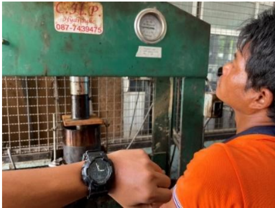
รูปที่ 6 การบดอัดด้วยวิธี Double plunger ด้วยแรงสถิติ 25,000 ปอนด์
