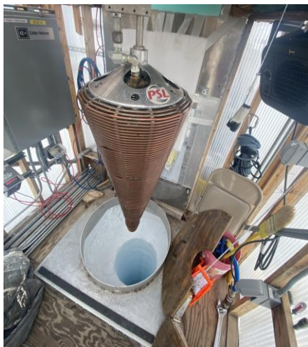
รูปที่ 3 การเจาะด้วยพลังงานความร้อน (Thermal Drilling) ในโครงการ IceCube Upgrade ในขณะที่ทำการติดตั้งหัวเจาะขึ้นจากหลุมหลังจากเสร็จสิ้นภารกิจ
