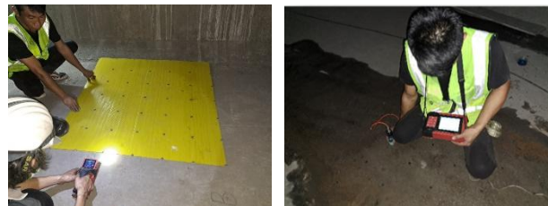
รูปที่ 10 การตรวจสอบด้วยวิธี Half-cell potential test
