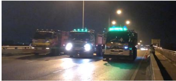
รูปที่ 11 การทดสอบสะพาน(Bridge Load Testing)
